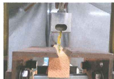
ダブルロックネイル 4.0X90 試験状況
