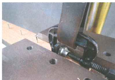
ダブルロックネイル 2.8X39 試験状況
