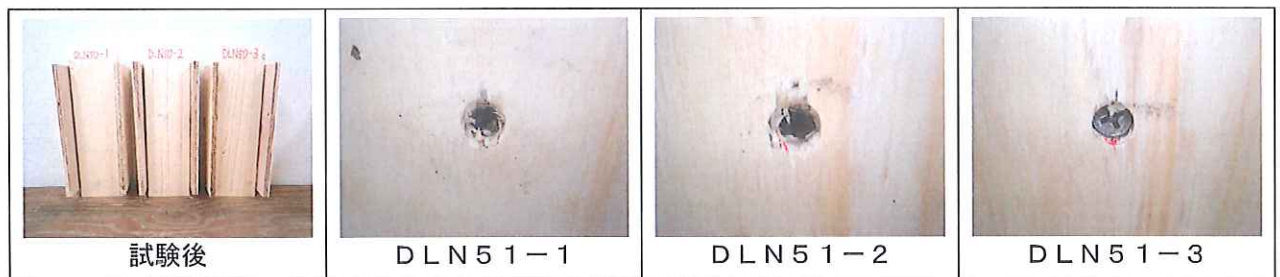
写真4-3 ダブルロックネイル51の試験後の試験体
